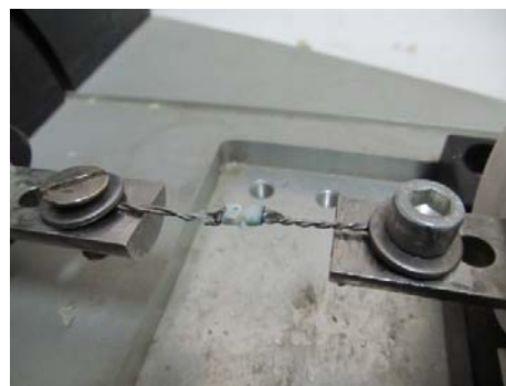
تصویر ۲: دستگاه در حال کشیدن نمونه های دمبلی شده با سرعت ۱mm/min
