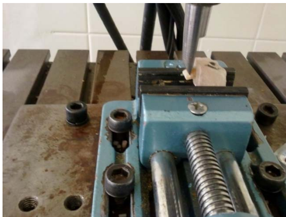
شکل ۲: قرار گرفتن هر یک از نمونه‌ها، درون دستگاه Universal Testing Machine و اعمال نیروی برشی به آنها
