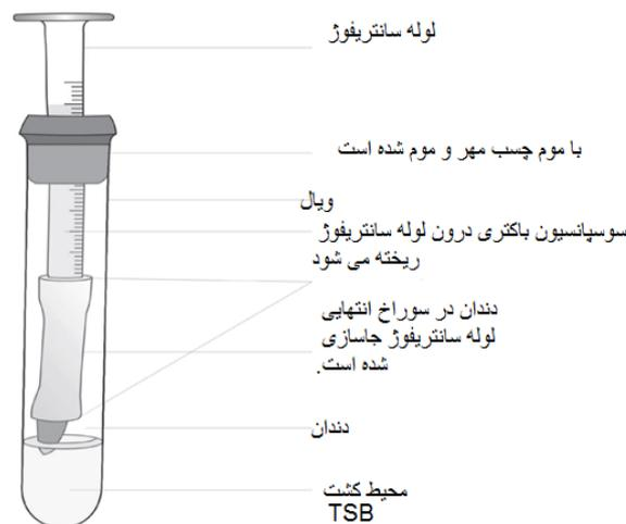
تصویر ۱- تصویر دستگاه استفاده شده در آزمایش
